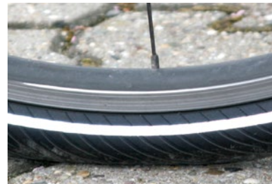
Ecco la situazione ideale. Lo pneumatico non appare molto deformato dal peso del ciclista.
