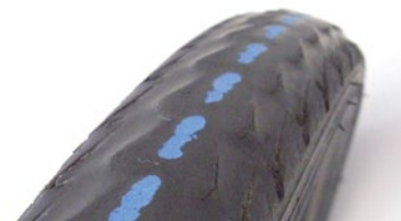
Lo strato di protezione antiforature è visibile. Lo pneumatico dovrà essere sostituito urgentemente.
